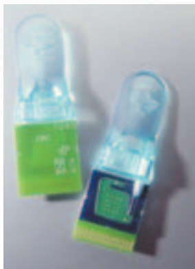
Fig. 6. Biochip de ADN eSensor™ comercializado por Motorola. Fuente: Motorola eSensor™ DNA Detection System ( http://www.motorola.com/lifesciences/esensor/tech_biochips.html ).
